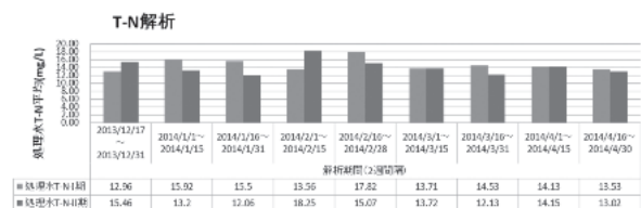
図10 処理水の全窒素(T-N)値の推移
