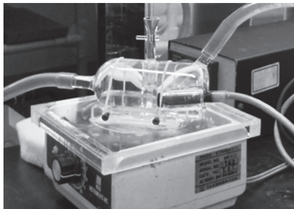
図2(b) 汚泥活性測定(DO測定/酸素電極付チャンバー)
